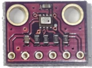
**BME280** ... misst Temperatur, Luftdruck und Luftfeuchte. Prinzipbedingt ist die Temperaturmessung immer etwas zu hoch, sie dient nur dem Abgleich des Druck- und Feuchtesensors. Daher muss dieser Sensor mit einem zusätzlichen Temperatursensor ergänzt werden, am besten den hochgenauen TMP117 mit  $\pm 0.1^\circ$  (oder wenn es billiger sein soll den MCP9808 mit  $\pm 0.5^\circ$ ).
