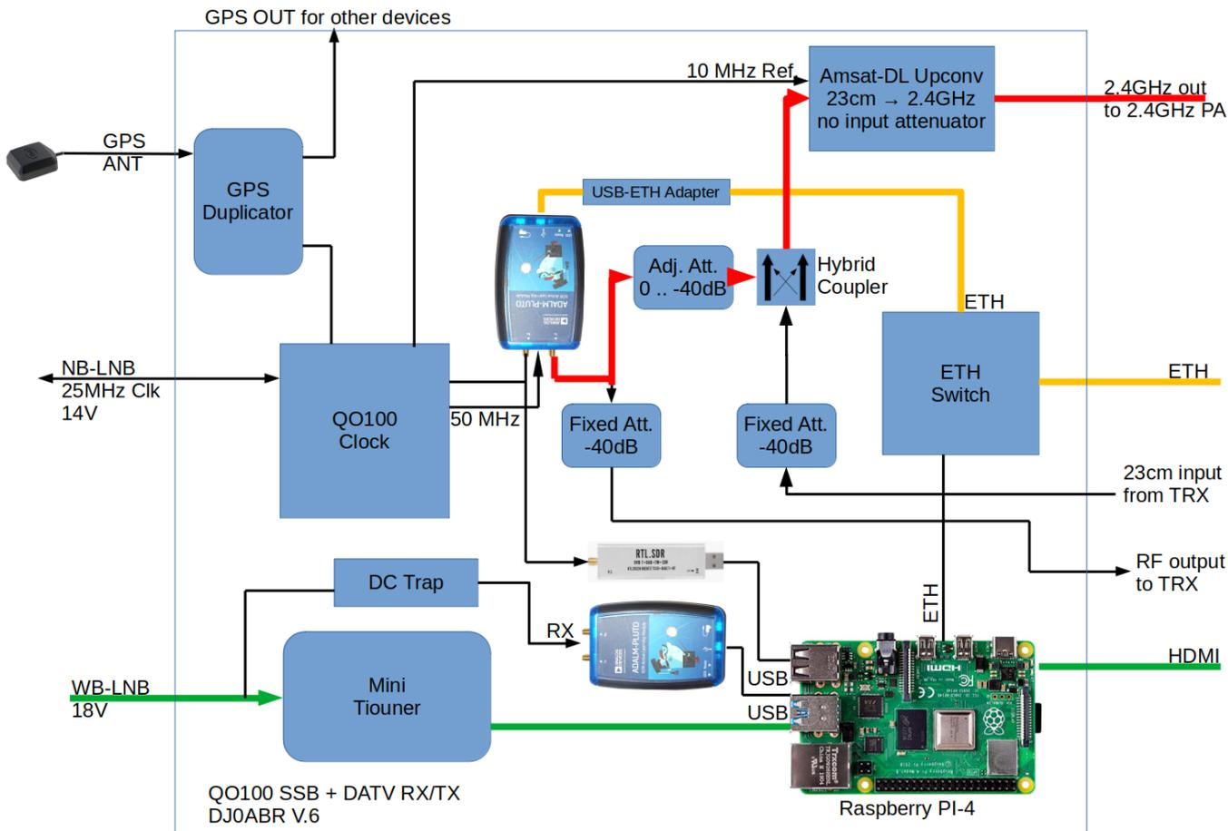
Das Empfangssignal (grün) geht vom LNB zum Mini Tiuner, der auch gleich die 18V Versorgung für den LNB erzeugt.
