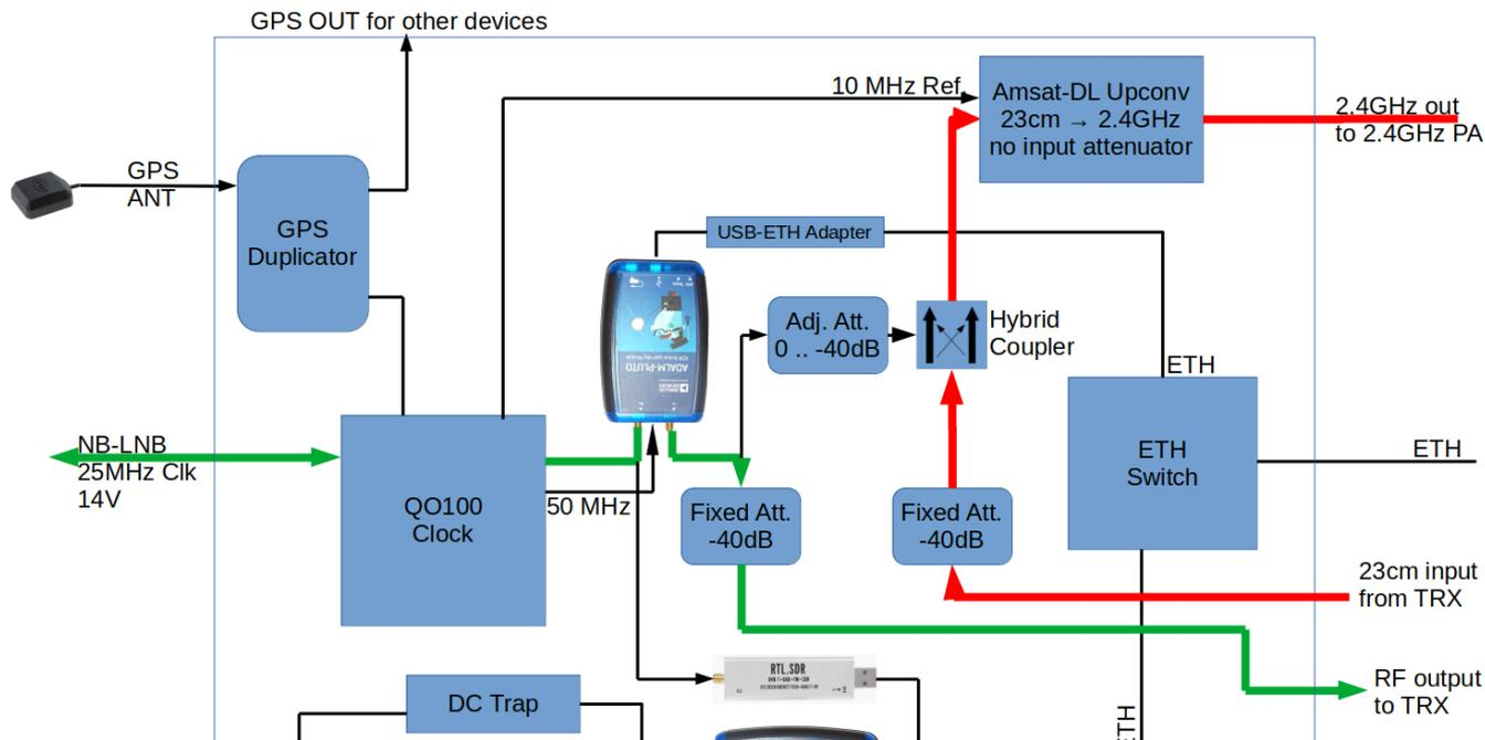
Das Empfangssignal (grün) kommt vom LNB und geht durch die Clock-Platine, wo 13,8V Versorgung sowie der 25 MHz LNB Takt zugeführt werden. Schließlich wird das Empfangssignal an den RX Eingang des Plutos geleitet. Das ist das gleiche wie zuvor im SDR Betrieb.
