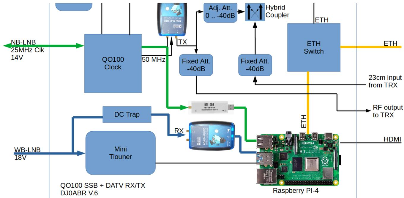
Das Signal des NB Transponders wird einem RTLSDR Stick zugeführt, das Signal des WB Transponders einem zweiten Pluto (wegen der hohen Bandbreite). Beide SDRs sind via USB mit dem Raspberry PI 4 verbunden. Im Raspberry läuft der WebSDR zwei mal, einmal in NB Ausführung und einmal in WB Ausführung.
