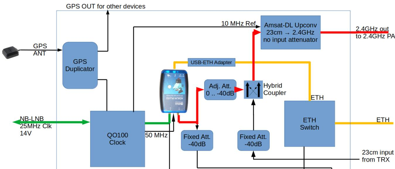
Die SDR Software greift via Ethernet auf den NB-Pluto zu. Dieser ist mit einem USB/ETH Adapter angeschlossen und hat eine feste IP-Adresse.
