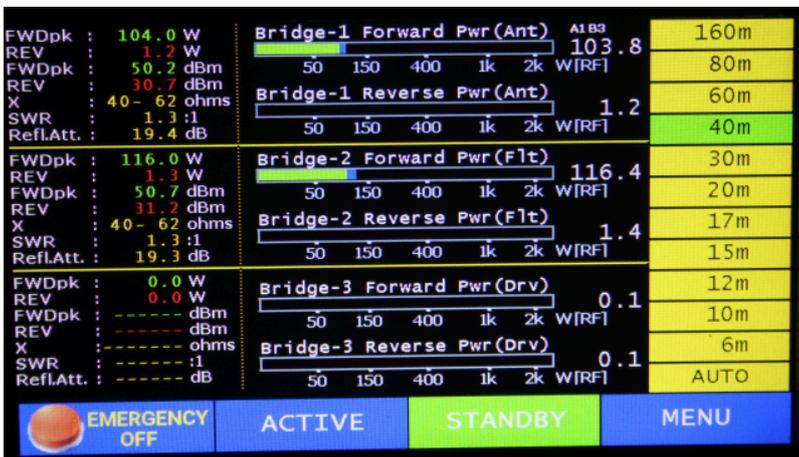
gibt einen vollständigen Überblick über alle drei Leistungs- / SWR-Koppler sowie einige berechnete Werte wie Reflexionsdämpfung und andere.
