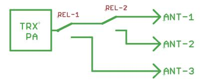
Die Relaisplatine benötigt 2 Relais, wie im Bild beschaltet.
